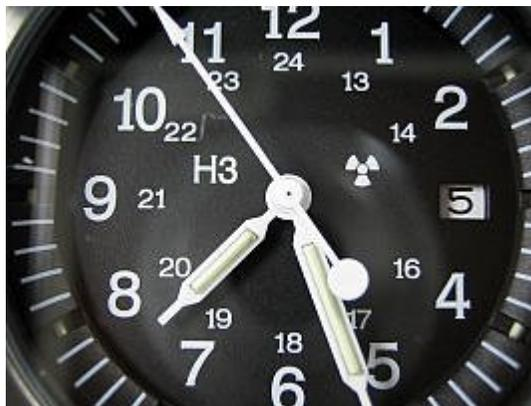
時計の針にトリチウム管が使われている時計。
