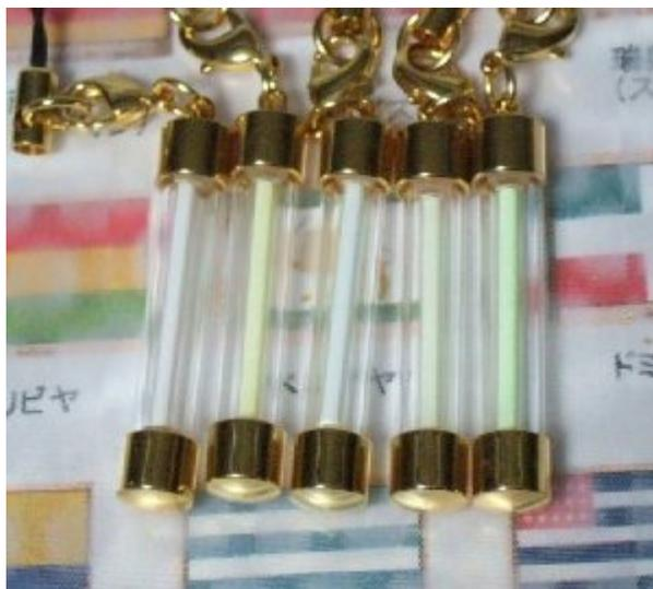
P: あわてないの！トリチウムは無色の気体です。これは、トリチウムを蛍光管に封入したものです。トリチウムからの粒子が、ガラス管の蛍光物質に当たって、発光させているのです。これは、
